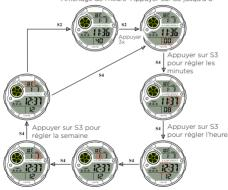
Appuyer sur S3 Appuyer sur S3 pour régler la date pour régler le mois
